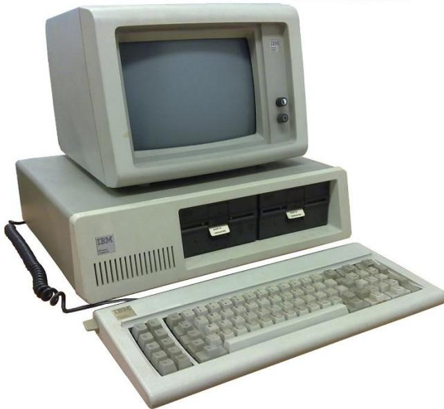
**Abb. 3** Der im August 1981 eingeführte IBM-PC 5150 in einer typischen Ausstattung mit zwei 5 1/4“ Diskettenlaufwerken. (Quelle: Wikimedia, Ruben de Rijcke, CC BY SA 3.0).
